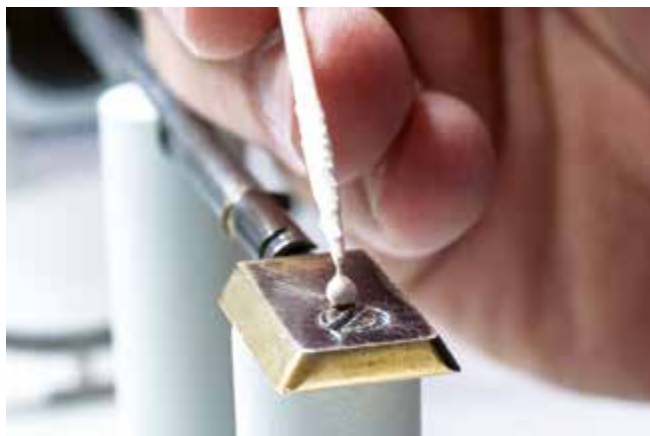
Vorbereitung einer Zementleim-Probe für die Untersuchung im Rasterelektronenmikroskop
